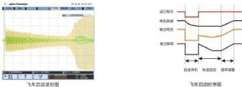
图 7-1 飞车启动波形图及时序图
